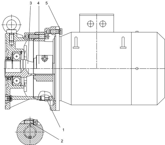
Die Schrumpfscheibe wird einbaufertig geliefert, sie sollte daher nicht auseinandergebaut werden. Die Schrumpfscheibe darf nicht ohne eingebaute Welle verspannt werden!
