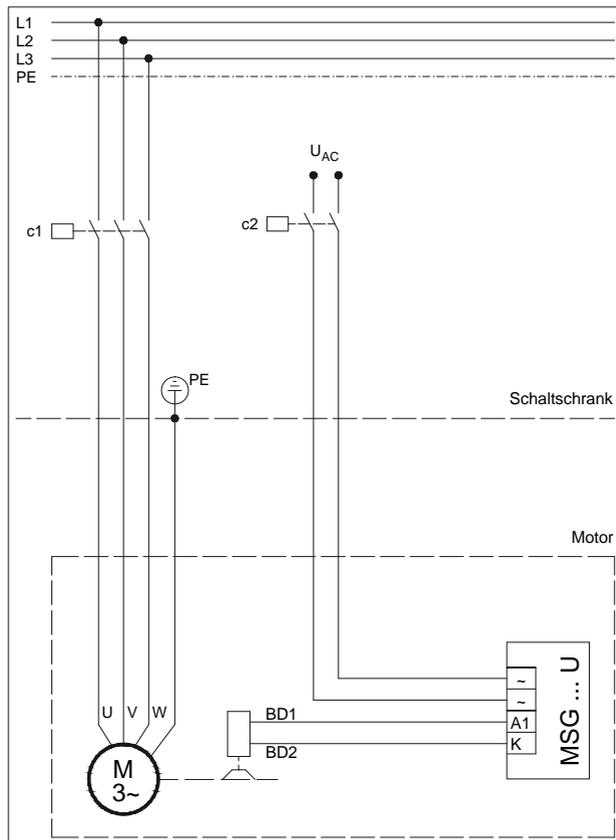
Bild 9: Separate Spannungsversorgung des Gleichrichters
