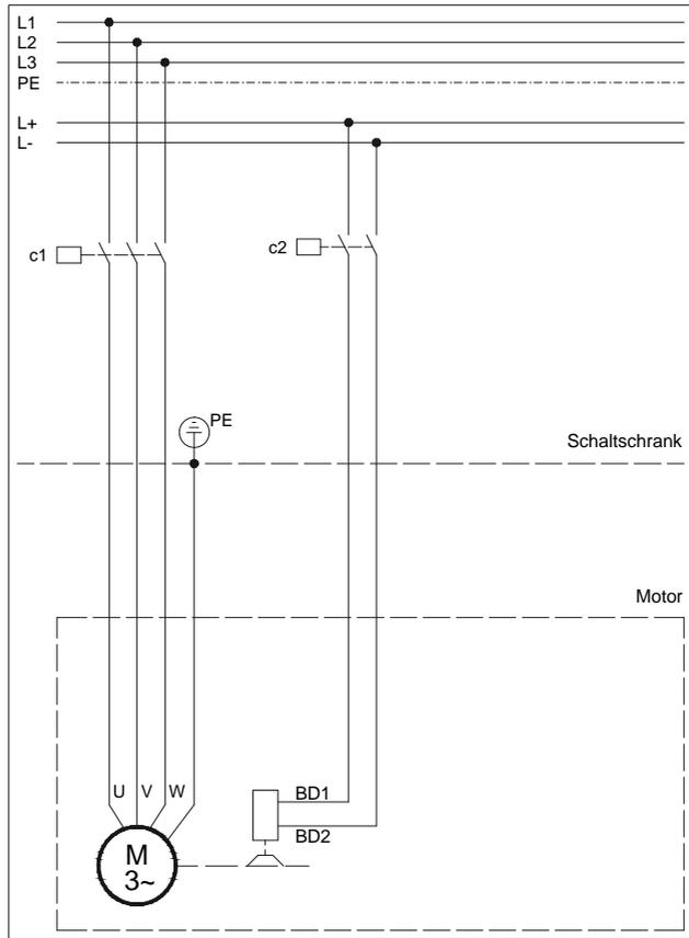
Bild 4: Direkte Gleichspannungsversorgung aus einem Steuernetz
