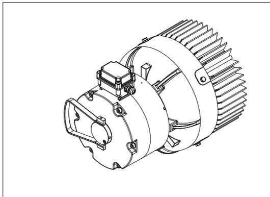
Bild 13: Bremse - Typen E../Z..075 und Z..100 - mit nicht arretierbarer Handlüftung
