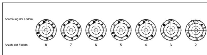
Bild 14: Anordnung der Federn bei Teilbestückung
