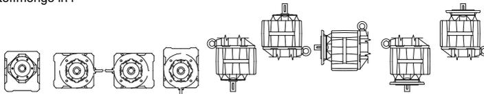
**BG04-BG100** (Anbaugehäuse mit Flansch- o. Fußbefestigung)
