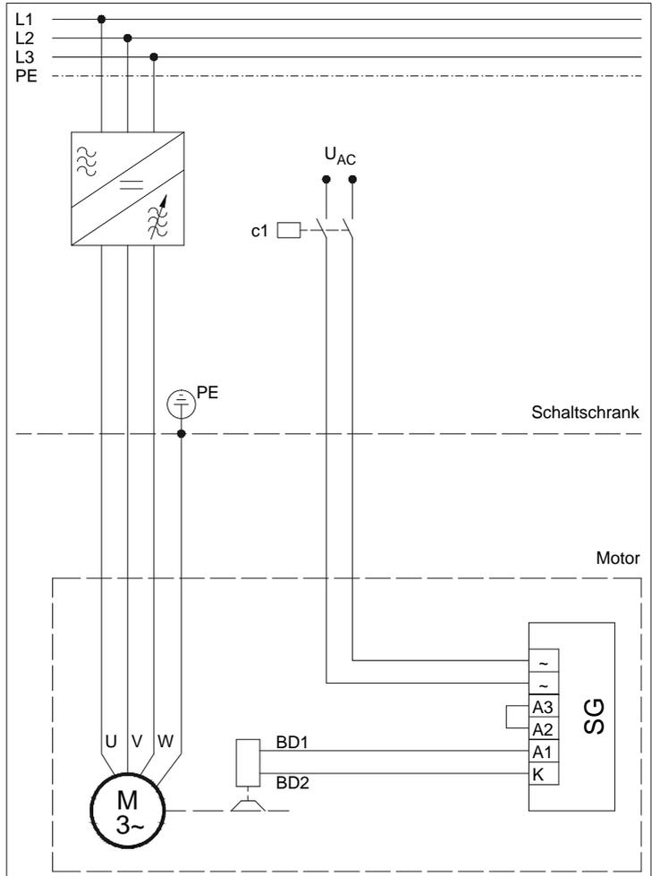
Bild 7: Separate Spannungsversorgung des Gleichrichters.
