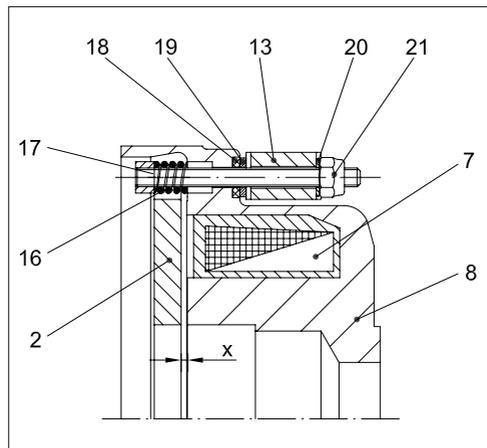
Bild 12: Montage der Handlüftung
