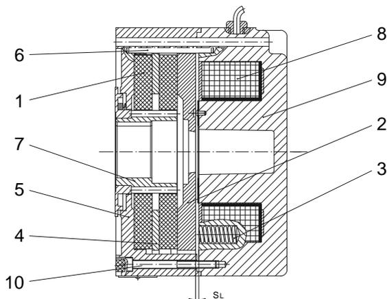
Bild 1: Zweiseiben-Federdruckbremse der Reihe Z..
