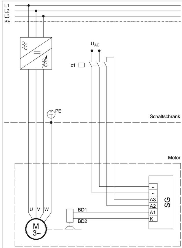
Bild 7a: Separate Spannungsversorgung des Gleichrichters.
