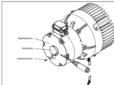
Bild 12: Bremse - Typen E../Z..075 und Z..100 - mit arretierbarer Handlüftung
