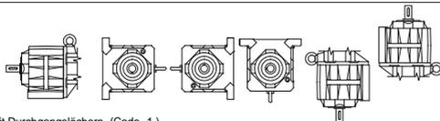
angepogener Fuß mit Durchgangslöchern (Code -1.)
