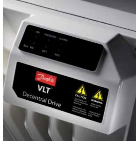
Die Kühlrippen des VLT® Decentral Drive FCD 302 sind schräg angeordnet. Damit ist ein schneller und zuverlässiger Ablauf von Reinigungs- und Desinfektionsmitteln sichergestellt. Sechs LED zeigen jederzeit den aktuellen Status des Geräts an. Für die Programmierung und weitere Informationen steht eine graphische Bedieneinheit bereit, die identisch zu den bewährten LCP-Bedieneinheiten der FC-Serie ist und ohne Öffnen des Gehäuses anzuschließen ist.
