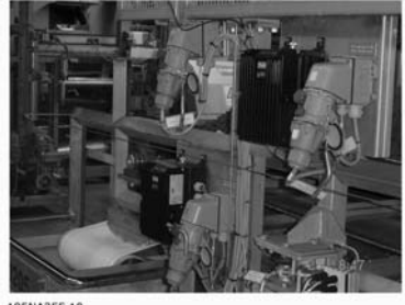
Abbildung 1.17: Effiziente Raumnutzung in der Lebensmittelindustrie mit dezentralen Motorsteuerungen von Danfoss
