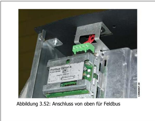
Abbildung 3.52: Anschluss von oben für Feldbus
