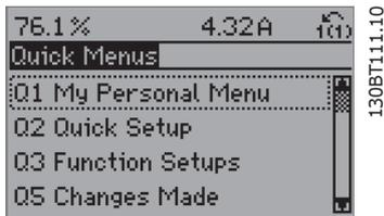
Abbildung 5.3: Schritt 2: Taste [Quick Menus] drücken (Quick-Menü-Optionen werden angezeigt).
