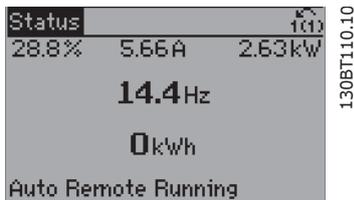
Abbildung 5.2: Schritt 1: Den Frequenzumrichter einschalten (On-LED leuchtet auf).
