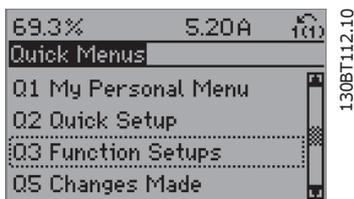
Abbildung 5.4: Schritt 3: Mit den Auf/Ab-Navigationstasten zu Funktionssätzen blättern. [OK] drücken.
