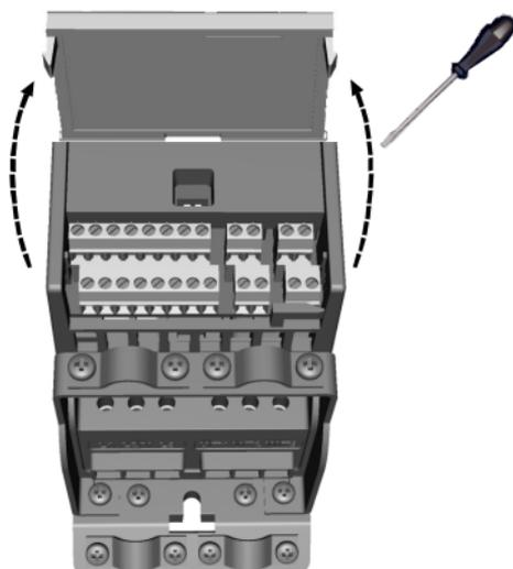
Figure 14: Öffnen der Abdeckung, MI1 - MI3
