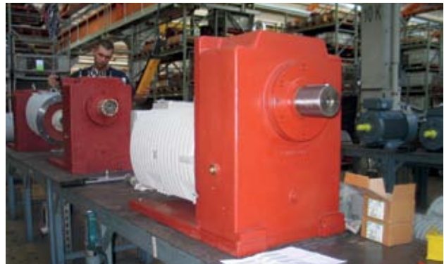
Rollgangausführung, SG200 ARG 200L 8, M_{max}= 1655 Nm
