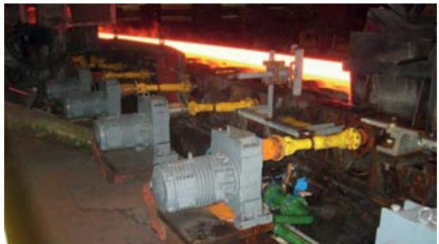
Zwischenrollgang mit S141-1A ARG 160L 4, M_{max}=1039 Nm
