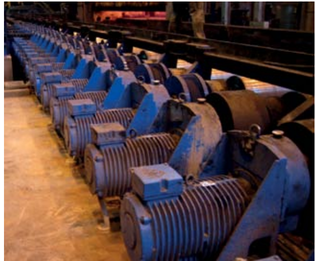
Ofenrollgang mit ARG 200L 12, M_{max}=1888 Nm
